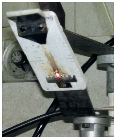
Испытание образца силиконовой резины по ГОСТ 27474.
