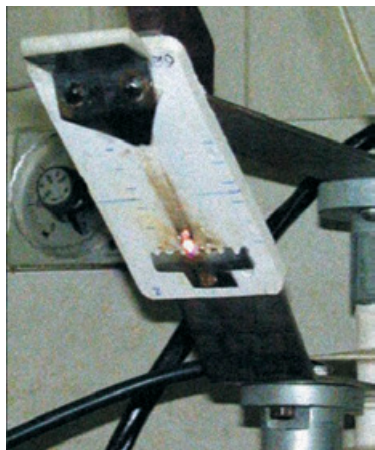
Испытание образца силиконовой резины по ГОСТ 27474.
