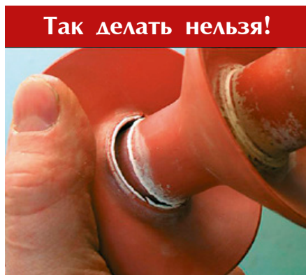
Попытка «насиленного» удаления цельнолитой защитной оболочки со стержня не приводит к оголению стеклопластикового стержня и его разгерметизации. Это свойство обеспечивает высокую стойкость изолятора к актам вандализма, способным повредить защитную оболочку.
