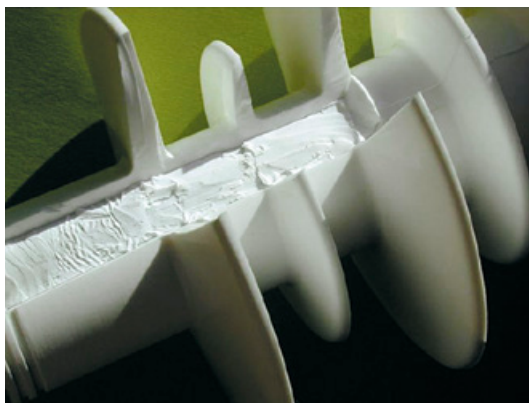
Попытка «насиленного» удаления цельнолитой защитной оболочки со стержня не приводит к оголению стеклопластикового стержня и его разгерметизации. Это свойство обеспечивает высокую стойкость изолятора к актам вандализма, способным повредить защитную оболочку.
