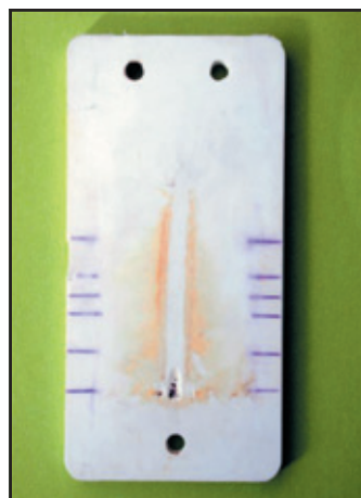
Образец, изготовленный из современной резины, после испытаний на трекингостойкость по ГОСТ 27474 при 4,5 кВ. (Испытания выдержал)
