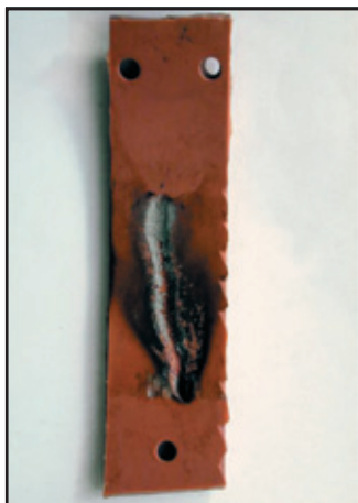
Образец, изготовленный из кремнийорганической резины, применявшейся в изоляторах первого поколения, после испытаний на трекингостойкость по ГОСТ 27474 при 3,5 кВ. (Испытания не выдержал)
