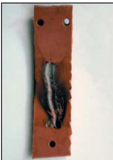
Образец, изготовленный из кремнийорганической резины, применявшейся в изоляторах первого поколения, после испытаний на трекинг-стойкость по ГОСТ 27474 при 3,5 кВ. (Испытания не выдержал)
