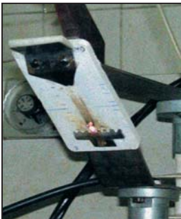
Испытание образца силиконовой резины по ГОСТ 27474.
