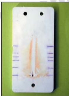
Образец, изготовленный из современной резины, после испытаний на трекинг-стойкость по ГОСТ 27474 при 4,5 кВ. (Испытания выдержал)
